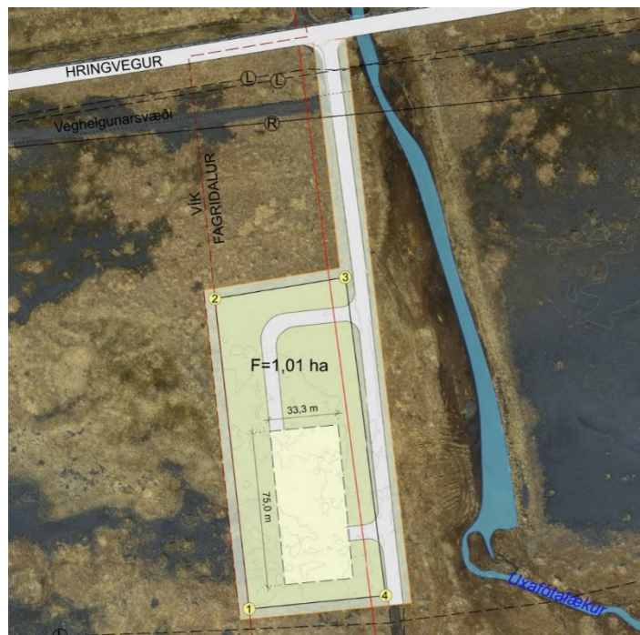
MYND 2.6 Deiliskipulagsuppdráttur af vinnslusvæðinu við Uxarfótarlæk.
