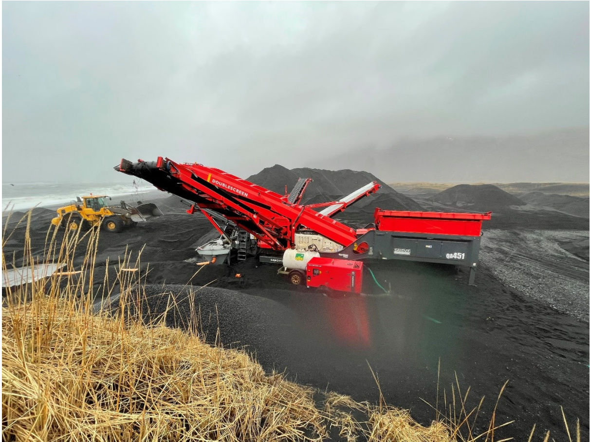
MYND 3.4 Harpa sem tekur á móti og flokkar efni sem komið er með úr fjörunni. Mynd tekin við prufuefnistöku fyrir nokkrum árum. Vinnslusvæðið við Uxarfótarlæk var ekki komið í gagnið á þessum tímapunkti og því fór vinnsla fram við fjöruna. Í framtíðinni verður aðalvinnslan við Uxarfótarlæk og bara lítil forhörun í fjörunni.
